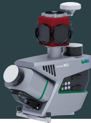
LiMobile M2 低成本移动激光扫描系统搭配倾斜 30 度安置的激光雷达和水平激光雷达、Ladybug5+ 全景相机，可快速获取道路及周围地物的三维数据。即使在 GPS 信号缺失区域，借助激光 SLAM 也可实现高精度扫描；设备预留丰富的扩展接口并可安装在不同车型中使用；搭配数字绿土自研的 LiDAR360 MLS 软件可实现一站式数据处理到行业成果交付，可满足道路资产普查、城市配电网分析、城市林业管理、智慧交通等领域行业应用。
